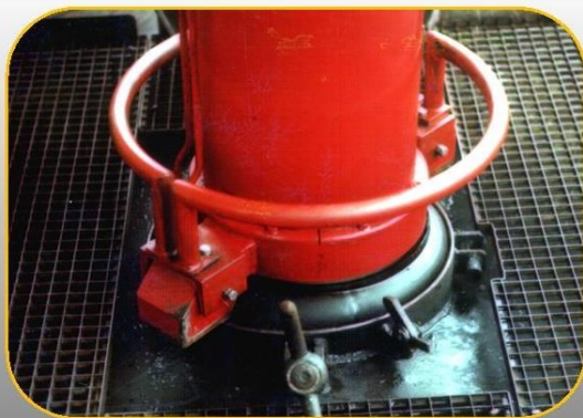
A) Aufblasbarer Dichtungsbalg (innere Domabdichtung)
