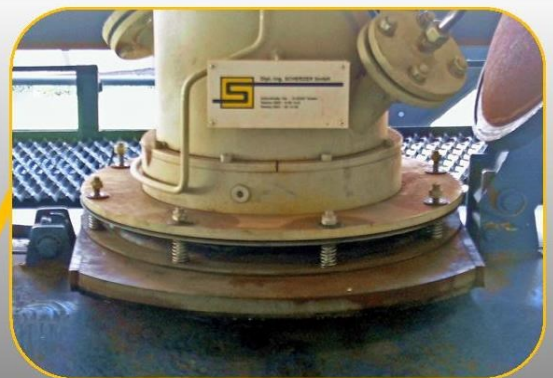
B) Federnd gelagerte Dichtplatte (äußere Domabdichtung)
